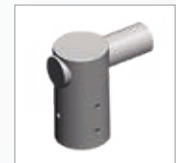
EINFACHAUSLEGER Mastaufsatz für Mastzopf 90mm Mastansatz 60mm Auslegerlänge 120mm KM-Z-AH-090-060
